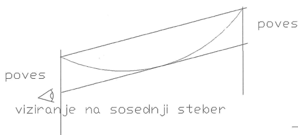
Slika 7: Metoda viziranja povesov (Vir: [1])
